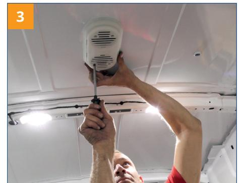
Vissez la plaque de couverture à l'intérieur du toit à l'aide des vis fournies. Et voilà !
