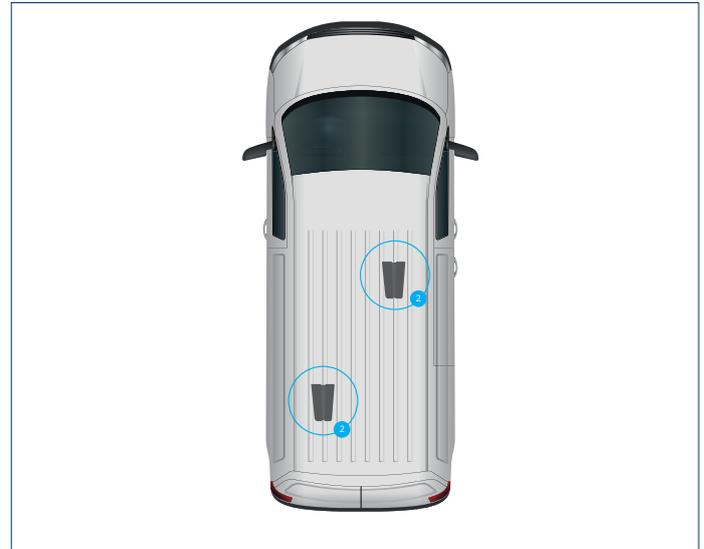
En cas de 2 ventilateurs, placez-les en diagonale, distribués uniformément. Divisez l'espace en 3 parties égales dans le sens de la longueur (mesurée à partir de la cloison jusqu'au hayon ou aux portes arrière) et placez l'Easy Aero pour 1/3 à l'avant et 1/3 à l'arrière et, en largeur, à la moitié de la demi-diagonale.
