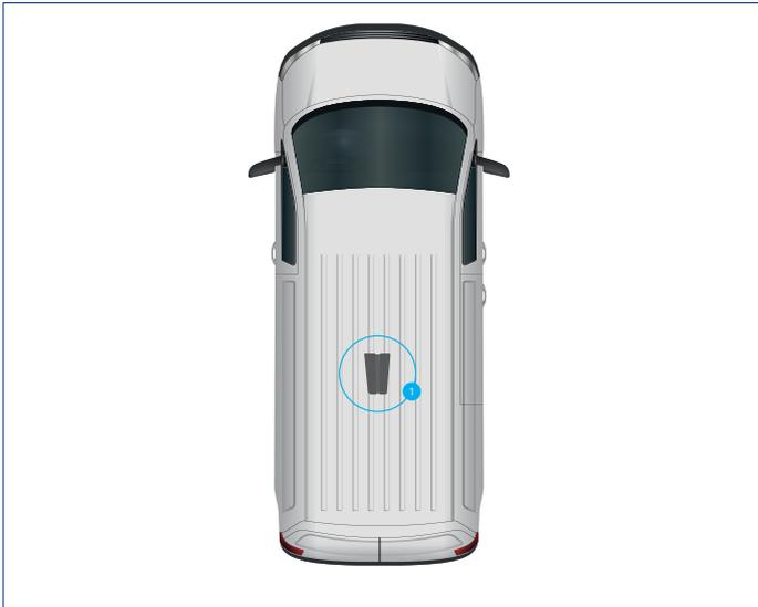
En cas d'1 ventilateur, essayez autant que possible de le placer au centre du toit, en mesurant à partir de la cloison jusqu'au hayon ou aux portes arrière.
